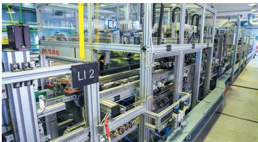
Линия автоматической сборки неэлектрической системы инициирования
